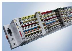
analoge Ein- und Ausgangsklemmen werden dabei modular und universell je nach Anforderung an einem Koppler angeordnet. Durch diese Bauweise können Erweiterungen und Änderungen auch während der Inbetriebnahmephase kurzfristig realisiert werden. Die Koppler sind für alle gängigen Feldbusse, Ethernet und die serielle Schnittstelle verfügbar.
